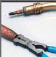
eliminación de salpicaduras del extremo de la boquilla
